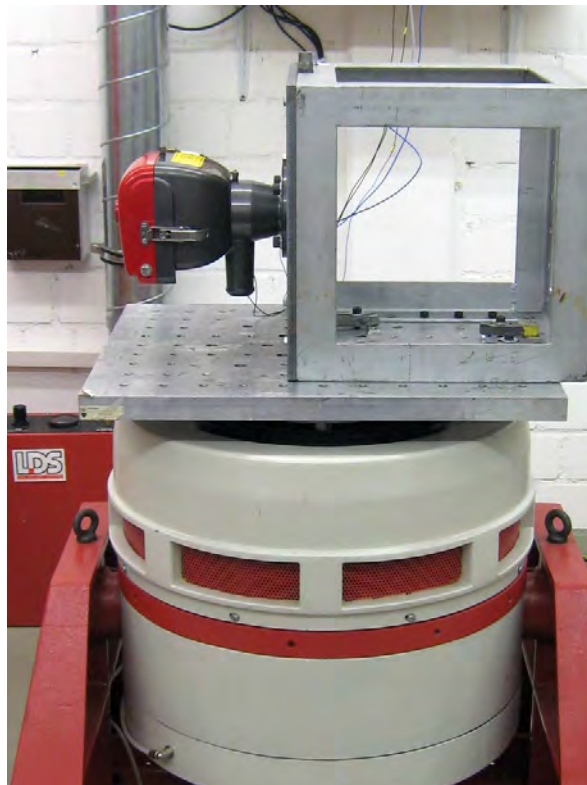
Abbildung 17: Einbaulage des Reflektors in der z-Achse
