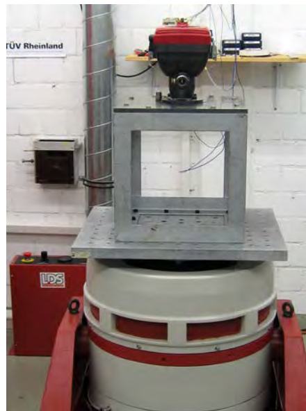
Abbildung 25: Einbaulage des Reflektors in der y-Achse
