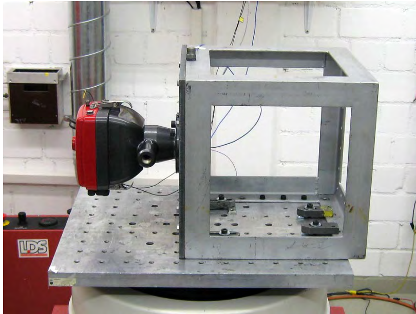
Abbildung 21: Einbaulage des Reflektors in der x-Achse
