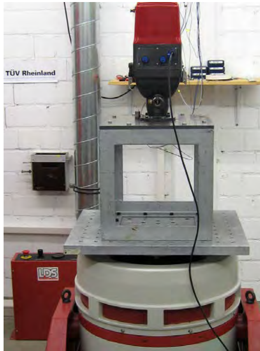
Abbildung 23: Einbaulage der Sende- / Empfangseinheit in der y-Achse
