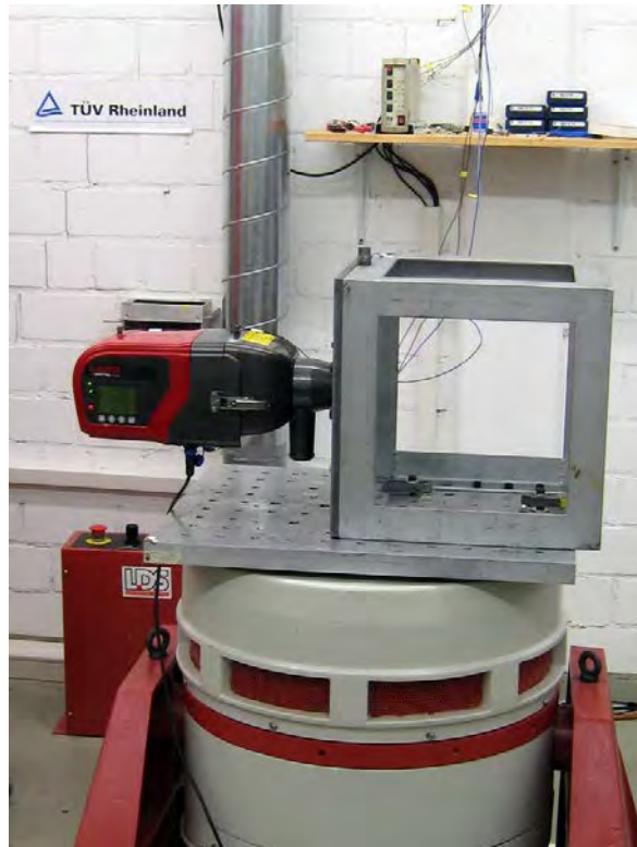
Abbildung 15: Einbaulage der Sende- / Empfangseinheit in der z-Achse
