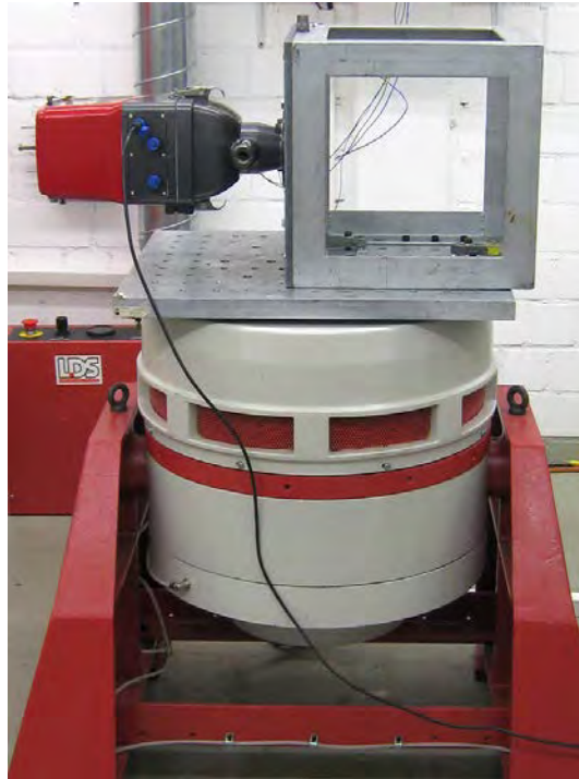
Abbildung 19: Einbaulage der Sende- / Empfangseinheit in der x-Achse
