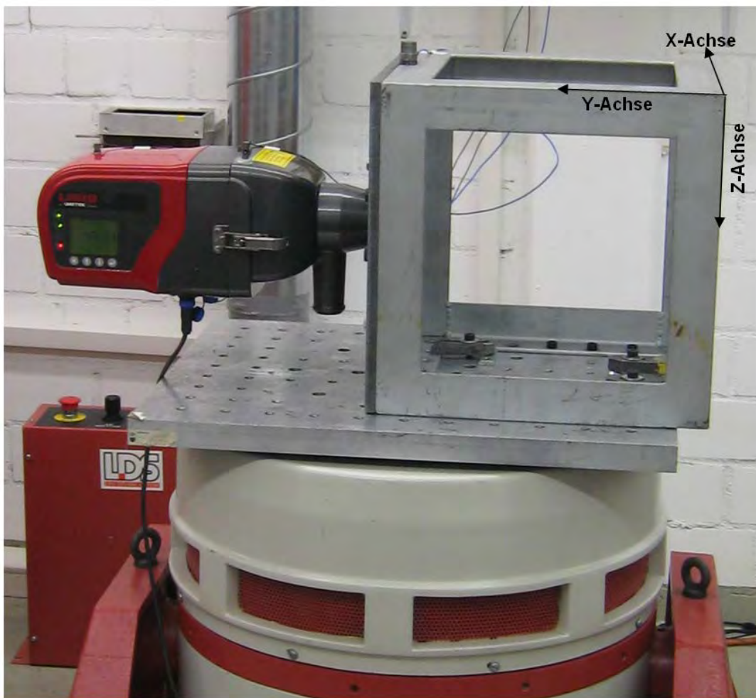
Abbildung 14: Lage der Achsen für die Sende / Empfangseinheit
