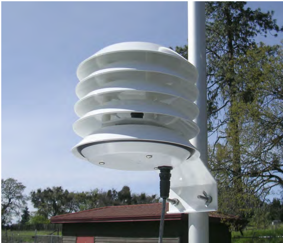
BX-596 Temperatur/Druck Sensor, installiert an einem BAM-1020 Probenahmerohr
