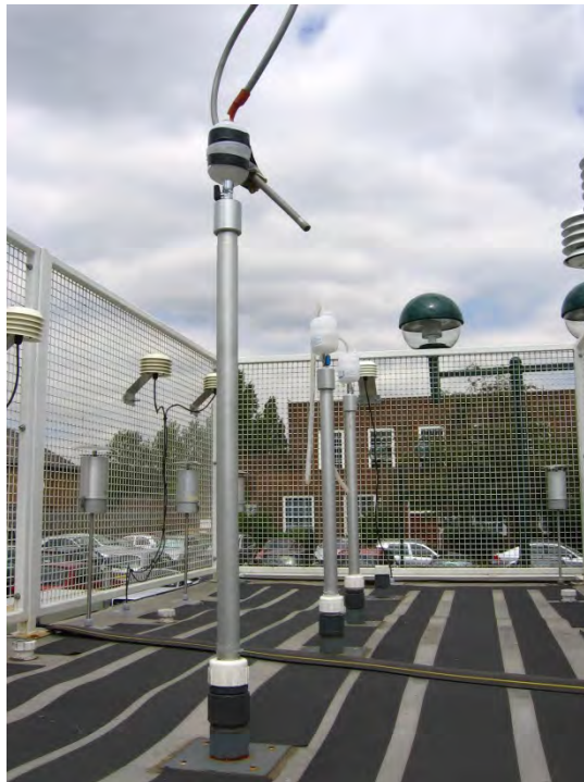
Abbildung 19: Nullfilter BX-302 im Feldeinsatz
