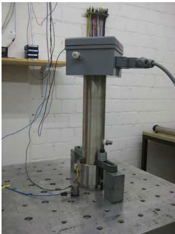
Abbildung 35: LaserGas II Empfängereinheit während der Vibrationsprüfung von Achse 3
