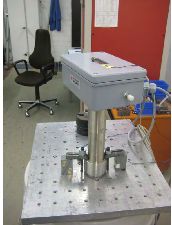
Abbildung 32: LaserGas II Sendeeinheit während der Vibrationsprüfung von Achse 3
