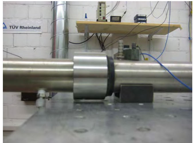
Abbildung 28: LaserGas II Sendeeinheit während der Vibrationsprüfung von Achse 2
