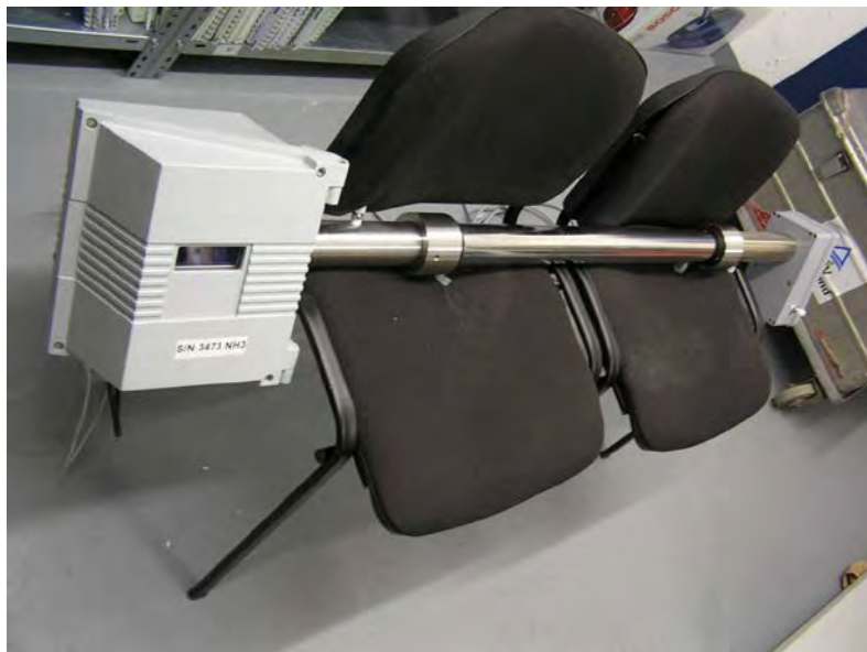
Abbildung 10: Unbeheizte Prüfgaszelle mit flanschmontierten Sende- und Empfängereinheiten der Messeinrichtung SERVOTOUGH Laser Model 2930
