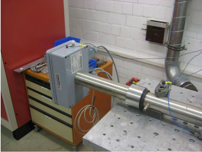
Abbildung 24: LaserGas II Sendeeinheit während der Vibrationsprüfung von Achse 1
