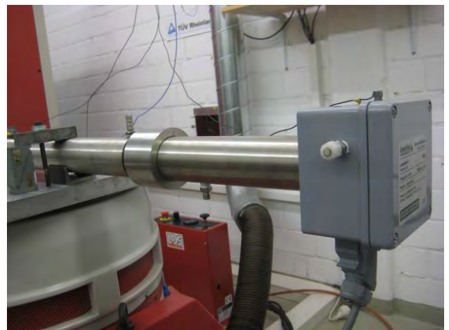
Abbildung 29: LaserGas II Empfängereinheit während der Vibrationsprüfung von Achse 2
