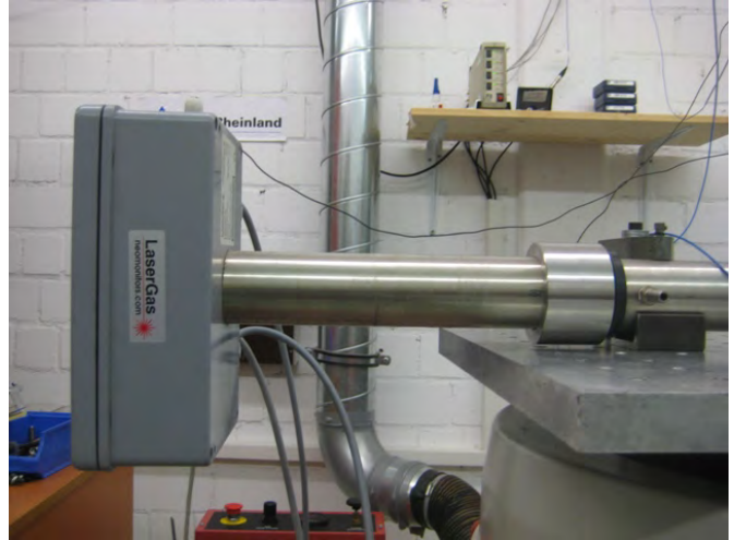
Abbildung 24: LaserGas II Sendeeinheit während der Vibrationsprüfung von Achse 1
