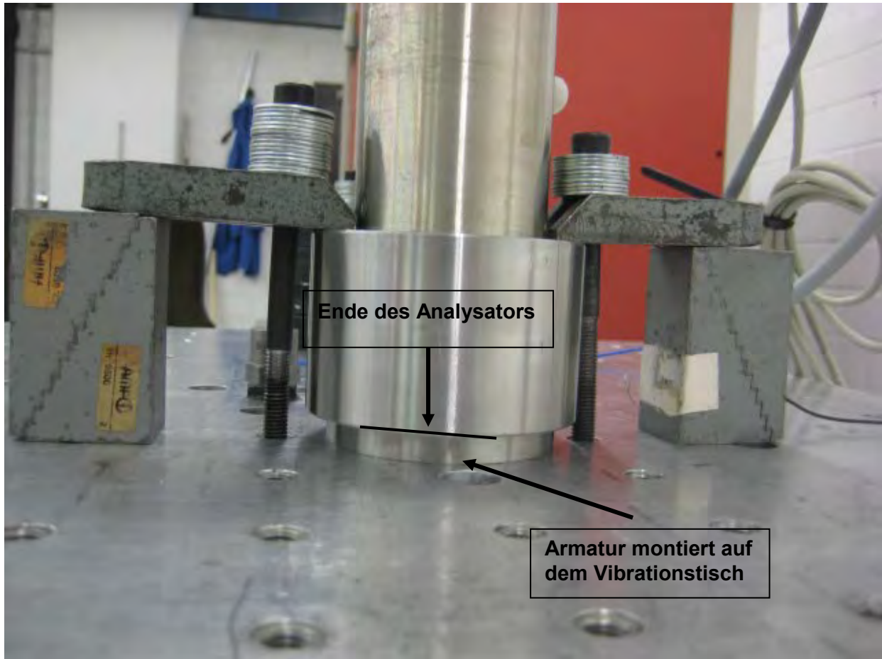
Abbildung 33: LaserGas II Sendeeinheit während der Vibrationsprüfung von Achse 3
