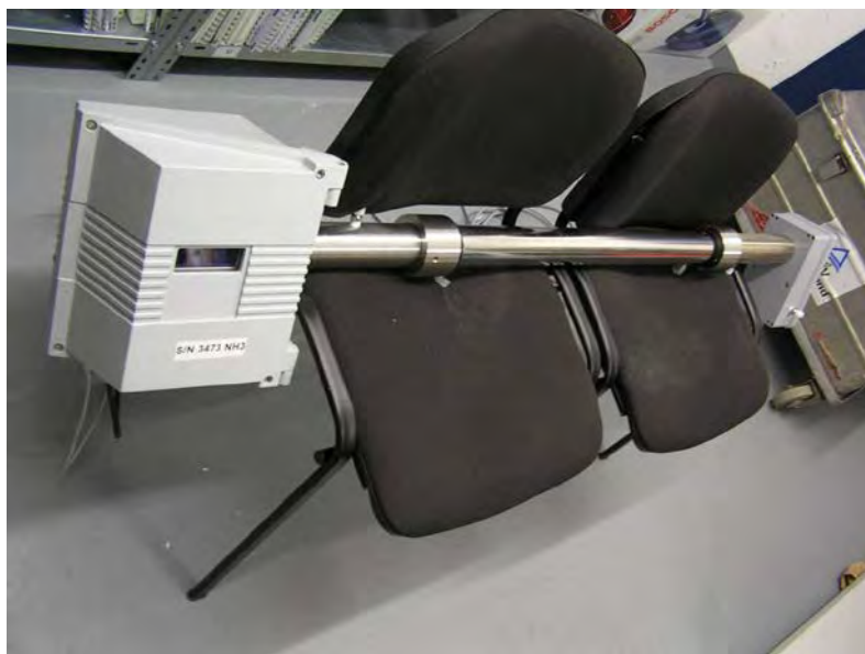
Abbildung 2: SERVOTOUGH Laser Model 2930 im Labortest
