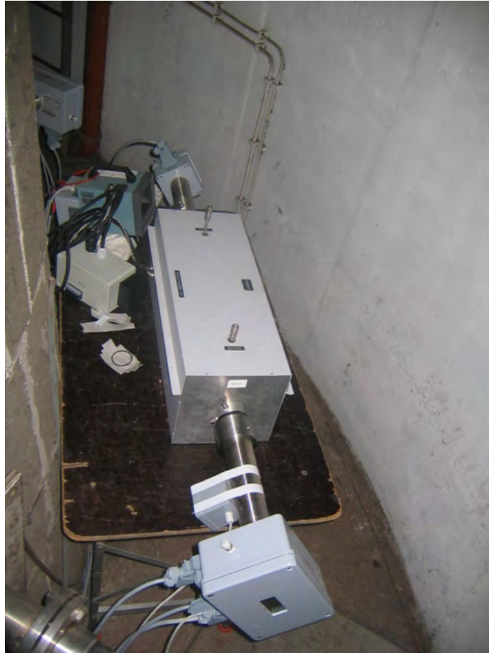
Abbildung 8: Beheizte Prüfgaszelle mit flanschmontierten Sende- und Empfängereinheiten mit der Messeinrichtung LaserGas II
