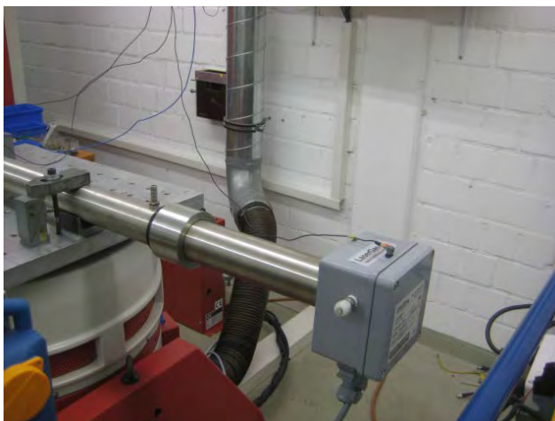
Abbildung 29: LaserGas II Empfängereinheit während der Vibrationsprüfung von Achse 2
