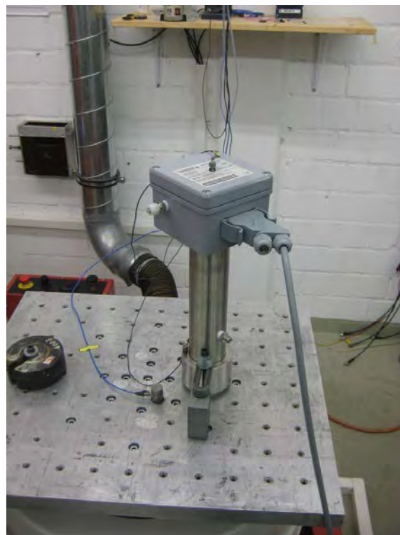
Abbildung 35: LaserGas II Empfängereinheit während der Vibrationsprüfung von Achse 3
