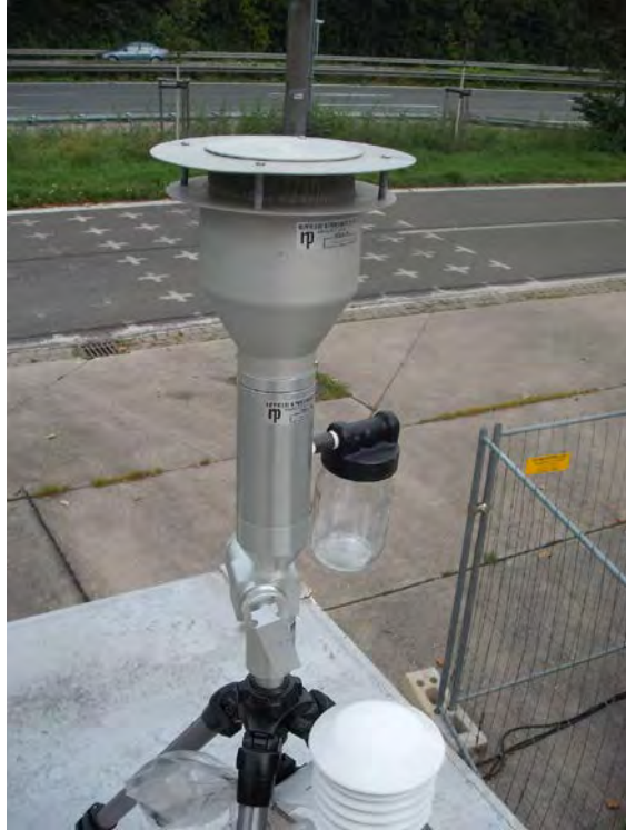
Abbildung 3: amerikanischer PM 10 -Probenahmekopf (Original Style, p/n 57-000596-0001) für TEOM 1405-F Ambient Particulate Monitor
