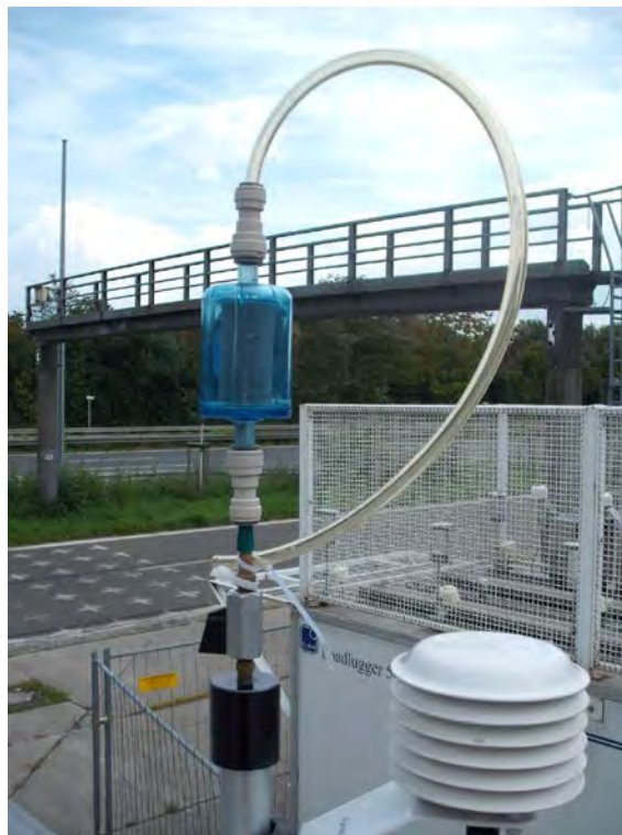
Abbildung 15: Nullfilter im Feldeinsatz
