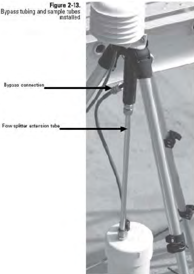
Bypass-Schlauch und Probenahmerohre nach Installation
