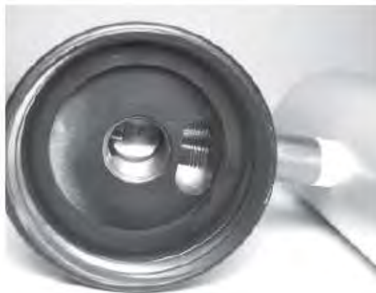
Deckel des Regenauffangbehälters
