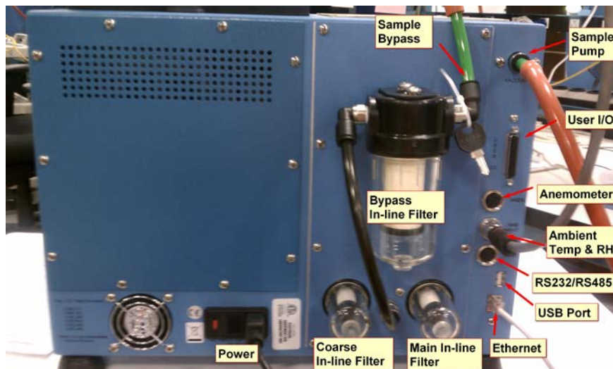
Abbildung 37: Ansicht Geräterückseite TEOM 1405-DF Ambient Particulate Monitor
