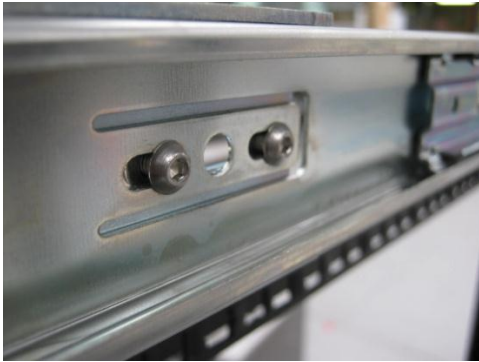
Abbildung 60 – Festschrauben der Rackbefestigungsadapter an die äußere Profile
