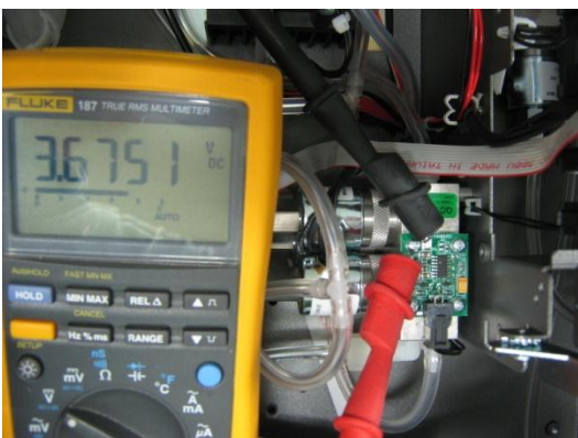
Abbildung 52 – Typischer Messwert der Prüfkontakten für die Messung des Zellendrucks
