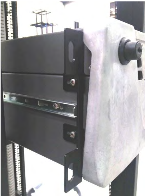
Abbildung 64 – Einpassen des Serinus in die Gleitschienen
