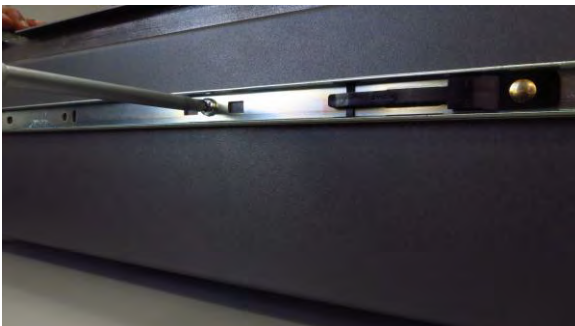
Abbildung 59 – Befestigung der inneren Profile auf dem Gehäuse
