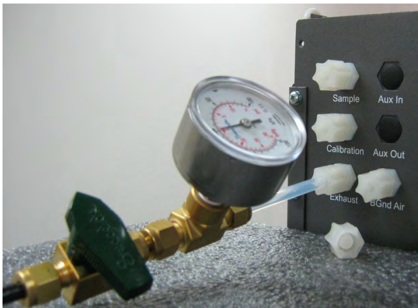
Abbildung 49 – Manometer an der Abluftöffnung
