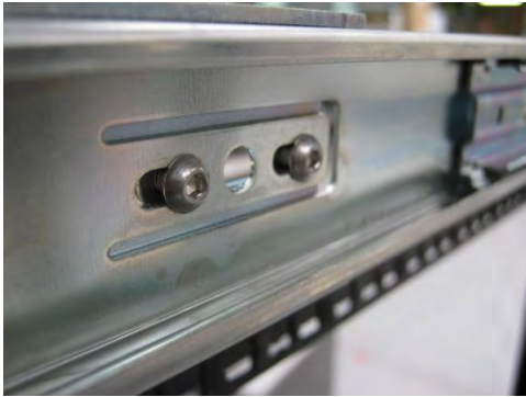
Abbildung 60 – Festschrauben der Rackbefestigungsadapter an die äußere Profile
