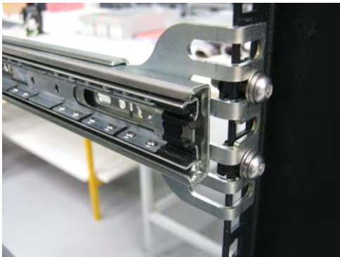
Abbildung 61 – Montage der inneren Profile auf dem Gehäuse
