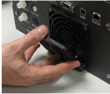
Abbildung 47 – Entfernen des Ventilatorfilters
