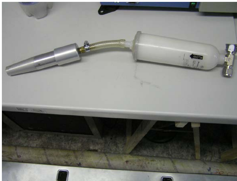
Abbildung 16: Nullfilter zur Erzeugung von schwebstaubfreier Luft, inkl. Anschlussadapter
