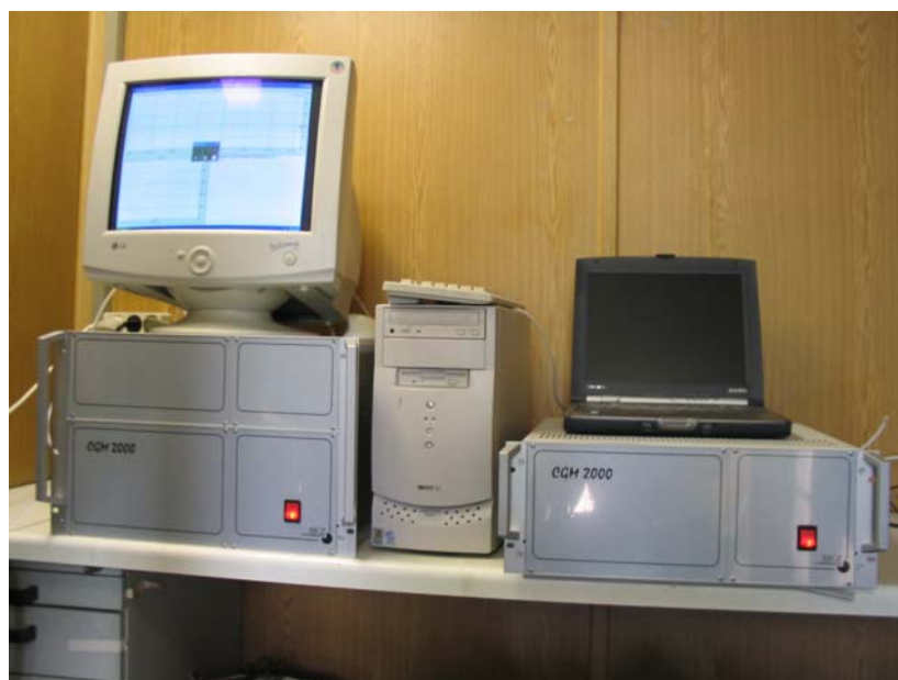
Abbildung 6: Aufbau des Permeationsofens und des Rechners zur Ansteuerung
