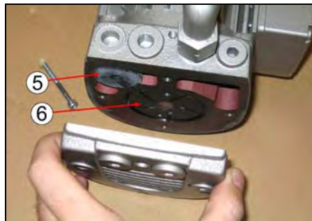
SCHRITT 3: Flansch ausbauen, um Zugriff zu erhalten auf den Ansaugfilter (5) und die Flügelzellen (6).
