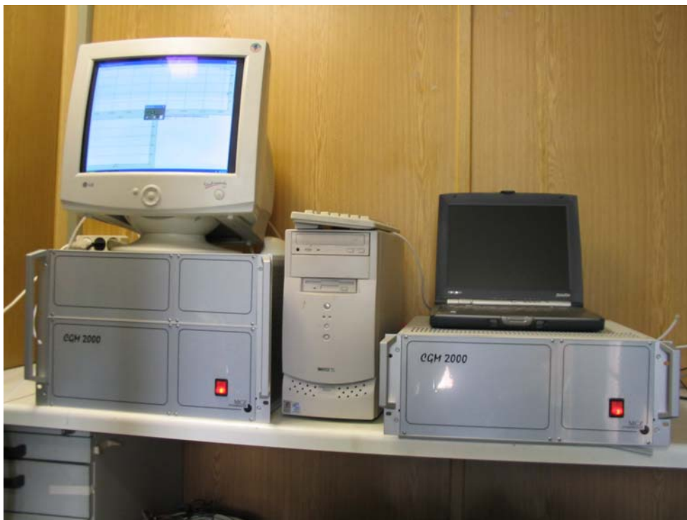
Abbildung 5: Aufbau des Permeationsofens und Rechner zur Ansteuerung
