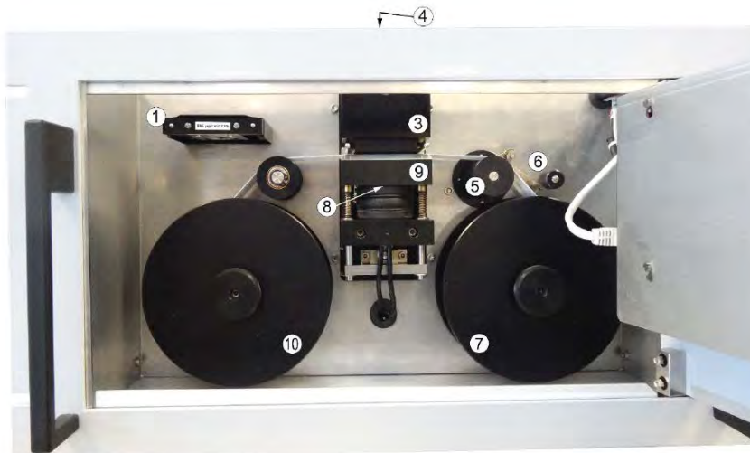
(1) Endmaß, (3) Quellenträger, (4) zusammenschiebbarer Stutzen am Probegaseingang, (5) Capstan, (6) Andruckrolle, (7) Aufwickelrolle, (8) Aufnahme des Geiger-Müller-Detektors, (9) Andruckvorrichtung, (10) Abwickelrolle.
