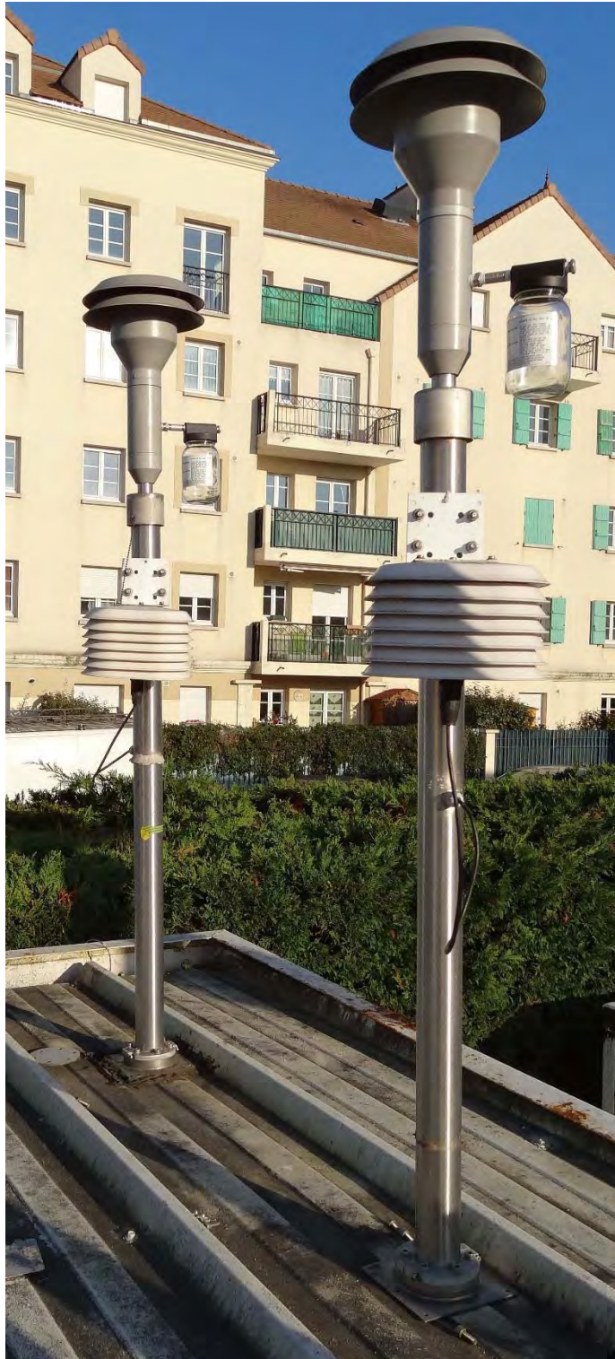
(1) Staubnahmekopf PM10, (2) Temperatur- und Feuchtigkeitssensor, (3) Probenahmestab RST, (4) siehe Abbildung 1–10, (5) Bereich des Stabs im Innern des Raums oder des Schanks.
