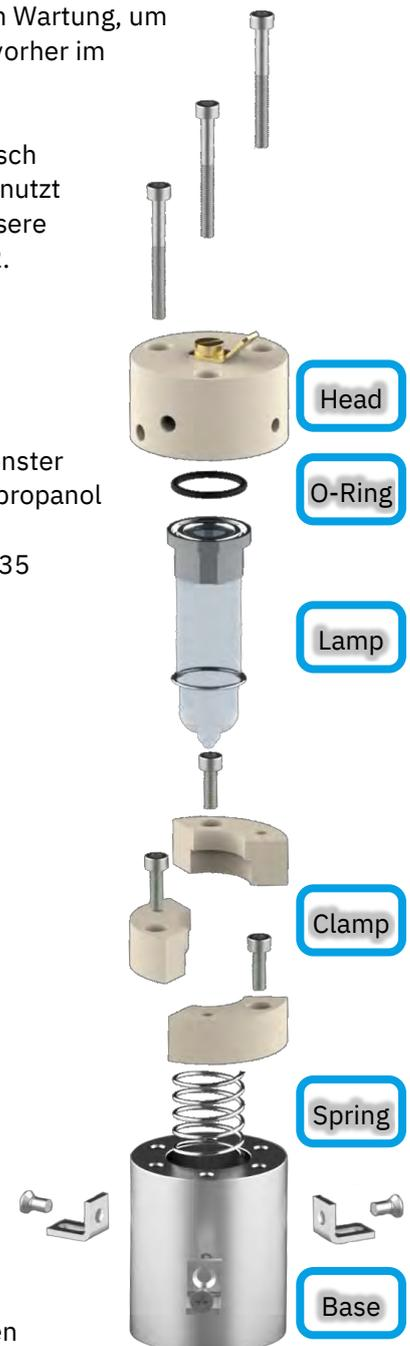
Bild 31 Explosionszeichnung des PID
