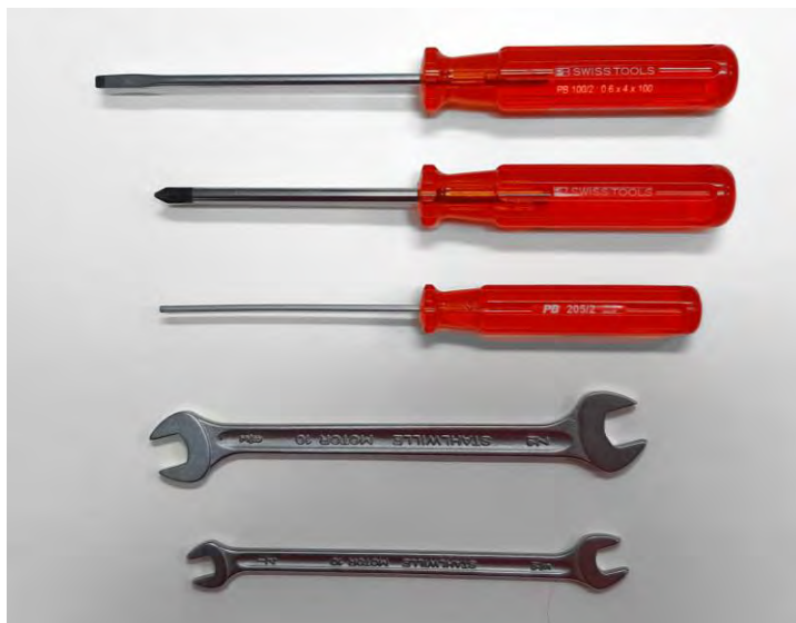
Bild 27 Erforderliche Mindestwerkzeuge für die Standardwartung und Inhaltsliste der Synspec-Toolbox
